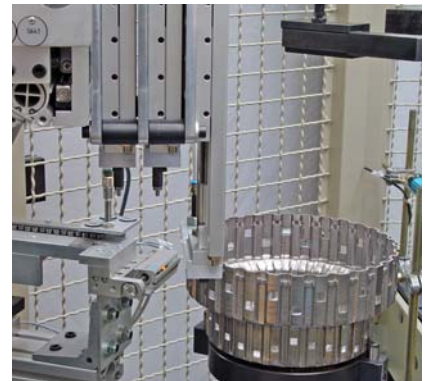
Löcher stanzen und Nieten einsetzen
