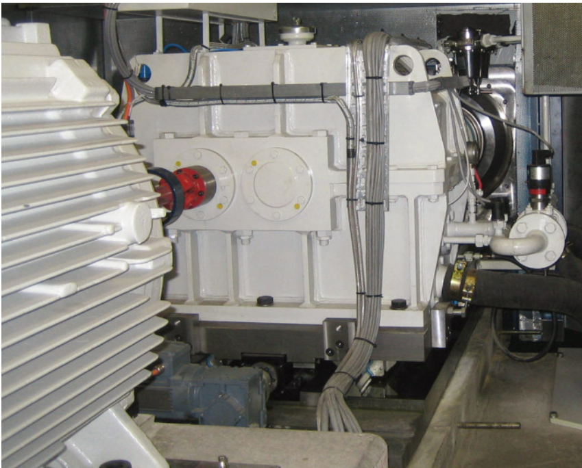
Antrieb mit Motor, Getriebe, Zwischenwelle und Verschiebeeinheit
