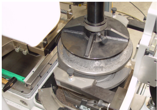
2-Ebenen Unwuchtausgleich durch Fräsen
