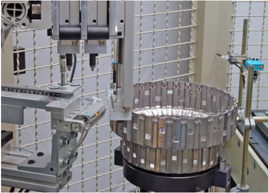
Unwuchtausgleich durch Stanzen und anschließendem Niet setzen
