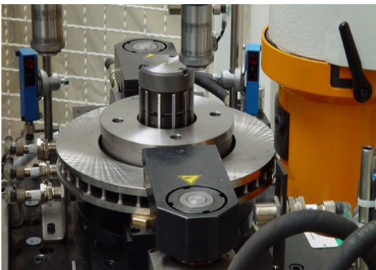
Unwuchtausgleich durch Fräsen oder Schleifen
