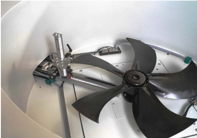
Einlagerung eines 700 mm Axiallüfters
